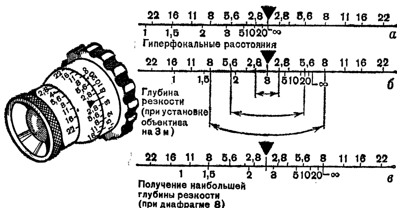
Рис. I. 6. Три варианта пользования шкалой глубины резкости: а — определение гиперфокальных расстояний, соответствующих выбранным значениям диафрагмы; б — определение глубины резкости при наводке объектива на заданное расстояние и выбор той или иной диафрагмы; в — получение наибольшей глубины резкости при выбранной диафрагме и определение расстояния до точки наводки объектива при этом условии
