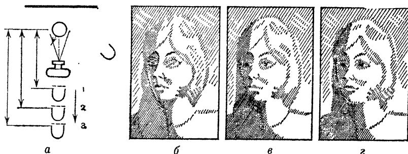
Рис. IV. 11. Схема изменения контраста освещения в зависимости от интенсивности подсветки
