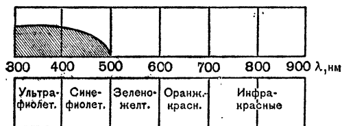
Рис. II. 3. Кривая спектральной светочувствительности бромистого серебра
